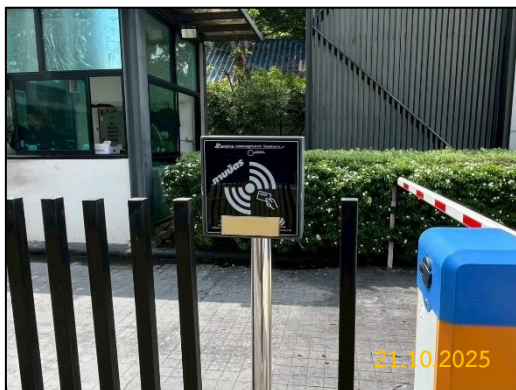
ภาพที่ 2-48 เครื่องตรวจจับ Key Card
